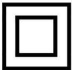
Bei Elektrogeräten der Schutzklasse II wird durch eine verstärkte oder doppelte Isolierung verhindert, dass das Gehäuse im Falle eines ersten Fehlers in Kontakt mit spannungsführenden Teilen kommt.
