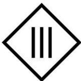
Elektrogeräte der Schutzklasse III arbeiten mit Schutzkleinspannung (SELV/PELV), die bei Wechselspannungsgeräten unter 50 Volt bzw. bei Gleichspannungsgeräten unter 120 Volt liegt. Sicherheitstransformatoren wandeln die Netzspannung in die Schutzkleinspannung um.
